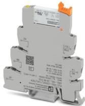
PLC-INTERFACE für Eingabefunktionen, bestehend aus Grundklemme PLC-BSC.../SEN mit Schraubanschluss und steckbarem Miniaturrelais mit Mehrlagen-Goldkontakt, zur Montage auf Tragschiene NS 35/7,5, 1 Schließer, Eingangsspannung 230 V AC/220 V DC
