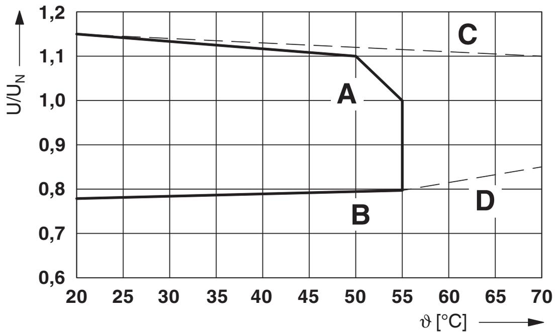
Kurve A: maximal zulässige Dauerspannung  $U_{\text{max}}$  bei kontaktseitigem Grenzdauerstrom, ohne Abstand
