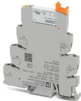
PLC-INTERFACE für Eingabefunktionen, bestehend aus Grundklemme PLC-BSC.../SEN mit Schraubanschluss und steckbarem Miniaturrelais mit Mehrlagen-Goldkontakt, zur Montage auf Tragschiene NS 35/7,5, 1 Schließer, Eingangsspannung 120 V AC/110 V DC
