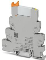
PLC-INTERFACE, bestehend aus Grundklemme PLC-BSC.../21 mit Schraubanschluss und steckbarem Miniaturrelais mit Mehrlagen-Goldkontakt, zur Montage auf Tragschiene NS 35/7,5, 1 Wechsler, Eingangsspannung 24 V DC
