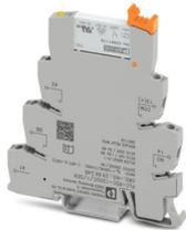
PLC-INTERFACE für Eingabefunktionen, bestehend aus Grundklemme PLC-BSC.../SEN mit Schraubanschluss und steckbarem Miniaturrelais mit Leistungskontakt, zur Montage auf Tragschiene NS 35/7,5, 1 Schließer, Eingangsspannung 120 V AC/110 DC
