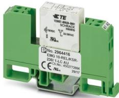
Relaismodul, mit fest eingelötetem Kleinschaltrelais, Goldkontakt für kleine Leistungen, 1 Schließer, Eingangsspannung 230 V AC/DC
