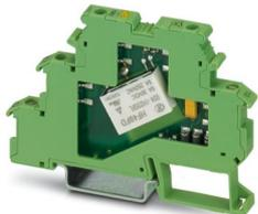
Relaisklemme für Sensor, mit fest eingelöteten Miniaturrelais, Kontakt (AgNi+Au): kleine bis mittlere Leistungen, 1 Schließer, Eingangsspannung 24 V AC/DC, zur Montage auf NS 35/7,5, Klemmenbreite 6,2 mm
