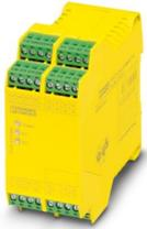
Sicherheitsrelais zur Not-Halt- und Schutztürüberwachung bis SIL 3 oder Cat. 4, PL e nach EN ISO 13849, 1- oder 2-kanaliger Betrieb, 8 Freigabestrompfade,  $U_S = 24 \text{ V DC}$ , steckbare Push-in-Klemme
