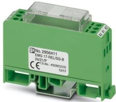
Relaismodul, mit fest eingelötetem Remanenz-Kleinschaltrelais, mit plusschaltender Diodenbeschaltung, Kontakte (AgSnO): kleine bis große Leistungen, 1 Wechsler, Eingangsspannung 24 V DC
