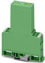
Leistungs-Solid-State-Relais, mit Leuchtanzeige und Schutzbeschaltung im Ein- und Ausgangskreis, Eingang: 24 V DC, Ausgang: 12-60 V DC/ max. 3 A
