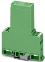
Leistungs-Solid-State-Relais, mit Leuchtanzeige und Schutzbeschaltung im Ein- und Ausgangskreis, Eingang: 12 V DC, Ausgang: 12-60 V DC/ max. 3 A
