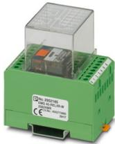
Relaismodul, mit fest eingelötetem Industrirelais, Kontakt: 2 Wechsler, für Sammelstörmeldungen, mit Eingangsdiodengatter in P-Polung (6 Dioden 1N4007) und Kondensator parallel zur Spule sowie einer Sammel-Leuchtanzeige, Eingangsspannung 230 V AC
