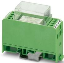
Relaismodul, mit fest eingelötetem Kleinschaltrelais, Kontakt (AgNi): mittlere bis große Leistungen, 1 Wechsler, Eingangsspannung 24 V AC/DC
