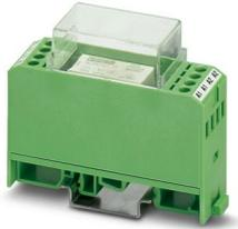
Relaismodul, mit fest eingelötetem Kleinschaltrelais, Kontakt (AgNi+Au): kleine bis große Leistungen, 1 Wechsler, Eingangsspannung 230 V AC/DC
