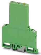
Eingabe-Solid-State-Relais, mit Leuchtanzeige und Schutzbeschaltung im Ein- und Ausgangskreis, Eingang: 230 V AC, Ausgang: 4 - 48 V DC/max. 100 mA
