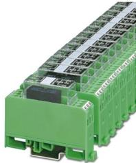
Relaismodul, mit fest eingelötetem Kleinschaltrelais, Kontakt (AgPd60 5 µm hartvergoldet): mittlere bis große Leistungen, doppelter A2-Anschluss, 1 Wechsler, Eingangsspannung 24 V AC/DC
