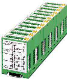
Relaismodul, mehrkanalig, mit 8 fest eingelöteten Kleinschaltrelais für Gleichspannung mit Leuchtanzeige und je 1 Schließer, Kontakt für mittlere bis große Leistungen, Eingangsspannung 24 V DC
