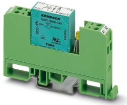
Relaismodul, mit fest eingelötetem Kleinschaltrelais, Kontakt (AgNi): mittlere bis große Leistungen, 1 Öffner, Eingangsspannung 24 V DC
