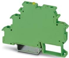
Leistungs-Solid-State-Relaisklemme, Eingang: 24 V DC, Ausgang: 3-30 V DC/3 A, Klemmenbreite 6,2 mm
