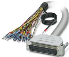
Konfektioniertes, geschirmtes Rundkabel; Anschluss 1: Einzeladern (50-polig) (Die Adern sind beschriftet und mit Aderendhülsen versehen. Das Schirmgeflecht ist auf ein separates Kabelende herausgeführt.); Anschluss 2: D-SUB-Buchsenleiste (1x 50-polig); Kabellänge: 3 m
