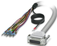
Konfektioniertes, geschirmtes Rundkabel; Anschluss 1: Einzeladern (15-polig) (Die Adern sind beschriftet und mit Aderendhülsen versehen. Das Schirmgeflecht ist auf ein separates Kabelende herausgeführt.); Anschluss 2: D-SUB-Buchsenleiste (1x 15-polig); Kabellänge: 6 m
