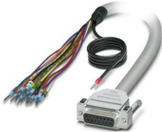
Konfektioniertes, geschirmtes Rundkabel; Anschluss 1: Einzeladern (15-polig) (Die Adern sind beschriftet und mit Aderendhülsen versehen. Das Schirmgeflecht ist auf ein separates Kabelende herausgeführt.); Anschluss 2: D-SUB-Buchsenleiste (1x 15-polig); Kabellänge: 4 m
