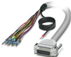
Konfektioniertes, geschirmtes Rundkabel; Anschluss 1: Einzeladern (15-polig) (Die Adern sind beschriftet und mit Aderendhülsen versehen. Das Schirmgeflecht ist auf ein separates Kabelende herausgeführt.); Anschluss 2: D-SUB-Buchsenleiste (1x 15-polig); Kabellänge: 0,5 m
