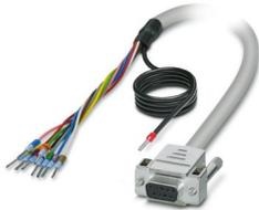
Konfektioniertes, geschirmtes Rundkabel; Anschluss 1: Einzeladern (9-polig) (Die Adern sind beschriftet und mit Aderendhülsen versehen. Das Schirmgeflecht ist auf ein separates Kabelende herausgeführt.); Anschluss 2: D-SUB-Buchsenleiste (1x 9-polig); Kabellänge: 1 m
