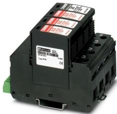
Überspannungsableiter Typ 2 für 5-Leiter-Stromversorgungssysteme (L1, L2, L3, N, PE), mit Steckverrastung und Fernmeldekontakt.
