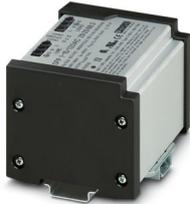
Geräteschutz, gem. Typ 3 / Class III, mit Netzentstörfilter gegen hochfrequente Störspannungen, für 1-phasige Stromversorgungsnetze mit separatem N und PE (3-Leitersystem: L1, N, PE), mit Fernmeldekontakt.
