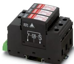
Überspannungsableiter für 4-Leiter-Stromversorgungssysteme (L1, L2, L3, PEN), bestehend aus Basiselement und Schutzsteckern, zur Montage auf NS 35.
