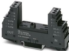
Basiselement zur Aufnahme eines Schutzsteckers mit Statusanzeige für zwei Signaladern mit gemeinsamem Bezugspotenzial, integrierte Funkenstrecke für hochohmige Anbindung des Grounds der Stecker-Schutzschaltung an das Erdpotenzial.
