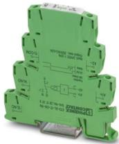
Zeitrelais mit Einschaltverzögerung (spannungsgesteuert) und einem einstellbaren Zeitbereich (0,1 s - 10 s), mit Zugfederanschluss
