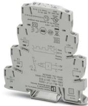
Zeitrelais mit Blinkerfunktion (impulsbeginnend) und einem einstellbaren Zeitbereich (3 s - 300 s), mit Schraubanschluss
