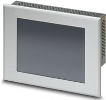
Webpanel mit 14,5 cm (5,7") grafikfähigem TFT-Display, 320 x 240 Pixel, 1x Ethernet, 2x USB und integriertem Micro-Browser
