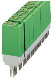
Steckbares Eingabe-Solid-State-Relais, mit Leuchtanzeige und Schutzbeschaltung im Ein- und Ausgangskreis, Eingang: 24 V DC, Ausgang: 8 - 48 V DC/max. 100 mA, steckbar auf Grundklemmenblöcke
