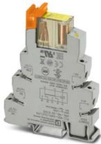
PLC-INTERFACE, bestehend aus Relaissockel und steckbarem Sicherheitsrelais mit zwangsgeführten Kontakten gemäß DIN EN 61810-3, Schraubanschluss, 2 Wechsler, zwangsgeführt, Freilaufdiode, Eingangsspannung: 24 V DC
