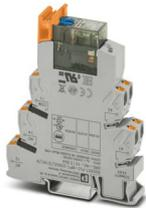
PLC-INTERFACE, bestehend aus Relaissockel und steckbarem Leistungskontaktrelais mit Handbetätigung, integrierter Status-LED, Push-in-Anschluss, 1 Wechsler, Brückengleichrichter, Eingangsspannung: 230 V AC / 220 V DC
