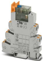
PLC-INTERFACE, bestehend aus Relaissockel und steckbarem Leistungskontaktrelais mit Handbetätigung, integrierter Status-LED, Push-in-Anschluss, 1 Wechsler, Brückengleichrichter, Eingangsspannung: 120 V AC / 110 V DC
