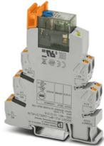
PLC-INTERFACE, bestehend aus Relaissockel und steckbarem Leistungskontaktrelais mit Handbetätigung, integrierter Status-LED und Freilaufdiode, Push-in-Anschluss, 1 Wechsler, Verpolschutzdiode, Freilaufdiode, Eingangsspannung: 24 V DC
