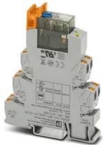
PLC-INTERFACE, bestehend aus Relaissockel und steckbarem Mehrlagen-Goldkontaktrelais mit Handbetätigung, integrierter Status-LED, Push-in-Anschluss, 2 Wechsler, Brückengleichrichter, Eingangsspannung: 24 V AC/DC
