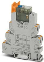
PLC-INTERFACE, bestehend aus Relaissockel und steckbarem Leistungskontaktrelais mit Handbetätigung, integrierter Status-LED und Freilaufdiode, Push-in-Anschluss, 2 Wechsler, Brückengleichrichter, Eingangsspannung: 48 V DC
