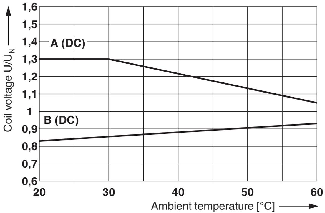
Kurve A: maximale Dauerspannung bei Grenzdauerstrom
