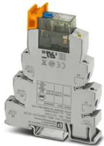
PLC-INTERFACE, bestehend aus Relaissockel und steckbarem Leistungskontaktrelais mit Handbetätigung, integrierter Status-LED, Schraubanschluss, 2 Wechsler, Brückengleichrichter, Eingangsspannung: 230 V AC / 220 V DC
