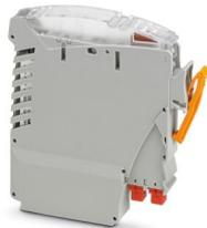
Relaismodul für VIP I/O-Marshalling-Basiselemente. Zum galvanisch getrennten Ankoppeln von 230-V-AC-Feldgeräten an digitale Eingänge. Integrierte Sicherung und Sicherungsausfallanzeige
