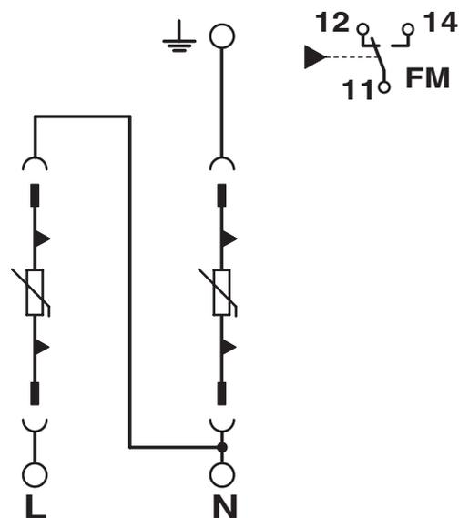
Der mit ‚L‘ und ‚N‘ beschriftete Sockel für AC-Anwendungen kann jeweils an ‚-‘ und ‚+‘ für DC-Anwendungen angeschlossen werden.
