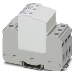
Steckbarer Überspannungsableiter, gem. Typ 2 / Class II, für 3-phasige Stromversorgungsnetze mit kombiniert verlegtem PE und N in einem Leiter (4-Leitersystem: L1, L2, L3, PEN), mit Fernmeldekontakt.
