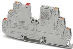
1-kanaliger, elektronischer Geräteschutzschalter zum Schutz von Verbrauchern an 24 V DC bei Überlast und Kurzschluss. Einfache Potenzialverteilung mit den Komponenten aus dem Reihenklemmensystem CLIPLINE complete. Mit festem Nennstrom. Zur Installation auf DIN-Tragschienen.
