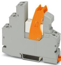
Vormontiertes Relaismodul mit Schraubanschluss, bestehend aus: Relaissockel, Leistungskontaktrelais, steckbarem Anzeige-/ Entstörm modul, Haltebügel. Kontaktausführung: 1 Schließer. max. Einschaltstrom bis 130 A peak, 80 A (20 ms) Eingangsspannung 24 V DC
