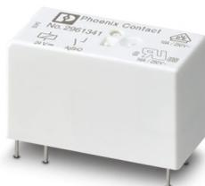
Steckbares Miniaturleistungsrelais, mit Leistungskontakt für hohe Einschaltströme bis 130 A Peak, 1 Schließer, Eingangsspannung 24 V DC
