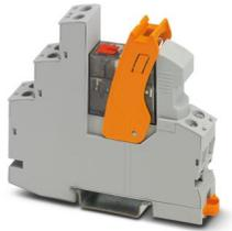
Vormontiertes Relaismodul mit Schraubanschluss, bestehend aus: Relaissockel, Relaishaltebügel, steckbarem Entstörmodul und Leistungskontaktrelais mit Prüftaste und integrierter Status-LED. Kontaktausführung: 2 Wechsler. Eingangsspannung: 120 V AC
