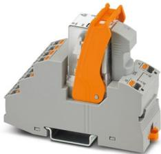
Vormontiertes Relaismodul bestehend aus: Relaissockel, Funktionssteckmodul, Leistungskontaktrelais und Haltebügel, zugelassen nach ATEX/IECEX (Zone 2) und Ex-Zone Class I, Div. 2, Push-in-Anschluss, 4 Wechsler, Varistor, Eingangsspannung: 120 V AC
