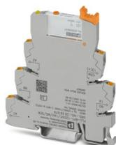
PLC-INTERFACE für Eingabefunktionen, bestehend aus Grundklemme PLC-BPT.../SEN mit Push-in-Anschluss und steckbarem Miniaturrelais mit Mehrlagen-Goldkontakt und Handbetätigung, 1 Schließer, Eingangsspannung 120 V AC/110 V DC
