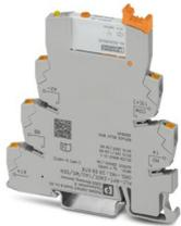
PLC-INTERFACE für Eingabefunktionen, bestehend aus Grundklemme PLC-BPT.../SEN mit Push-in-Anschluss und steckbarem Miniaturrelais mit Mehrlagen-Goldkontakt und Handbetätigung, 1 Schließer, Eingangsspannung 24 V DC
