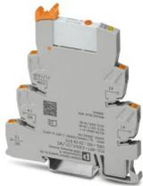
PLC-INTERFACE, bestehend aus Grundklemme PLC-BPT.../21 mit Push-in-Anschluss und steckbarem Miniaturrelais mit Leistungskontakt und Handbetätigung, 1 Wechsler, Eingangsspannung 230 V AC/220 V DC
