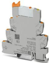
PLC-INTERFACE, bestehend aus Grundklemme PLC-BPT.../21 mit Push-in-Anschluss und steckbarem Miniaturrelais mit Leistungskontakt und Handbetätigung, 1 Wechsler, Eingangsspannung 12 V DC
