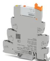
PLC-INTERFACE für Eingabefunktionen, bestehend aus Grundklemme PLC-BSC.../SEN mit Schraubanschluss und steckbarem Miniaturrelais mit Mehrlagen-Goldkontakt und Handbetätigung, 1 Schließer, Eingangsspannung 24 V DC
